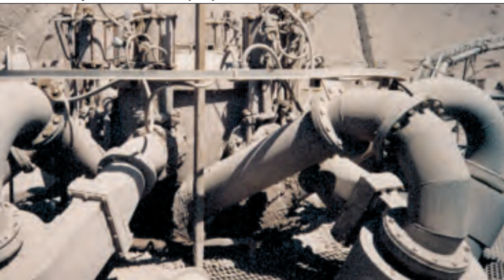
Válvula Flexgate® montada sobre un hydrocyclone.
