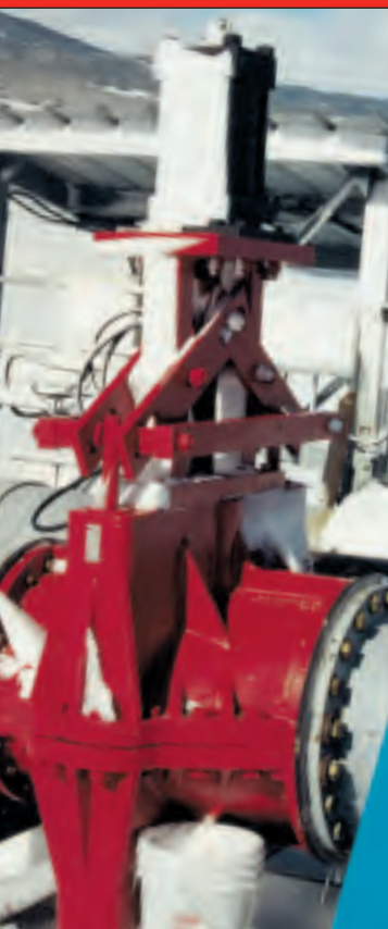
Línea central de alta presión, cerrando la válvula tipo pellizco para colas.
