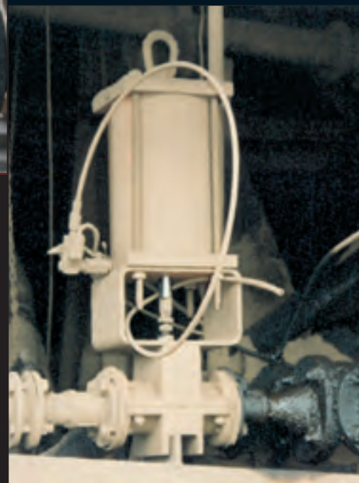
Válvula de alimentación de ácido en un proceso de alta lechada.
