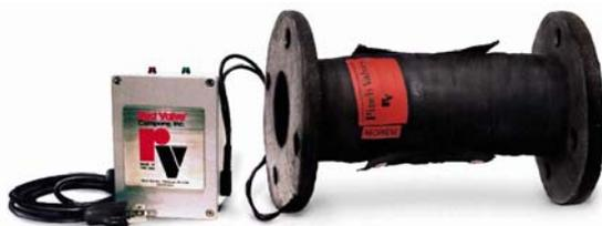
In die Schlauchmanschette kann ein „Frühwarnsystem“ als Verschleißanzeige integriert werden. Die Karkasse der Manschette wird mit zusätzlichen metallischen Gewebeeinlagen gefertigt. Bei Kontakt mit dem Produkt erfaßt eine Elektronik die Leitfähigkeitsänderung zwischen Rohr und Drahtgewebe. Dadurch lassen sich drohende Leckagen rechtzeitig erkennen und ungeplante Produktionsunterbrechnungen minimieren.
