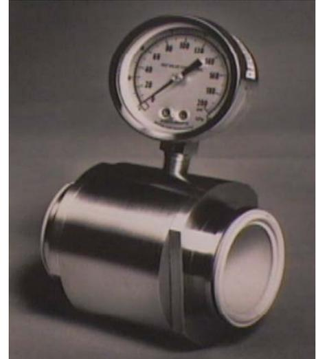
Im Unterschied zu den Standard- Rohrdruckmittlern ist die Serie 44 über die ganze Länge mit einem Liner ausgekleidet, der an den Enden als Dichtung zu den Rohrübergängen wirkt. Dadurch entstehen keine Toträume und Spülanschlüsse sind nicht erforderlich !
