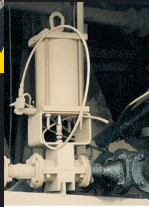
酸液进料阀用于堆浸工艺
